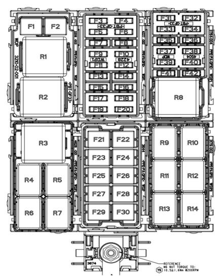
LOW VOLTAGE POWER DISTRIBUTION UNIT (LVPDU) FUSING
